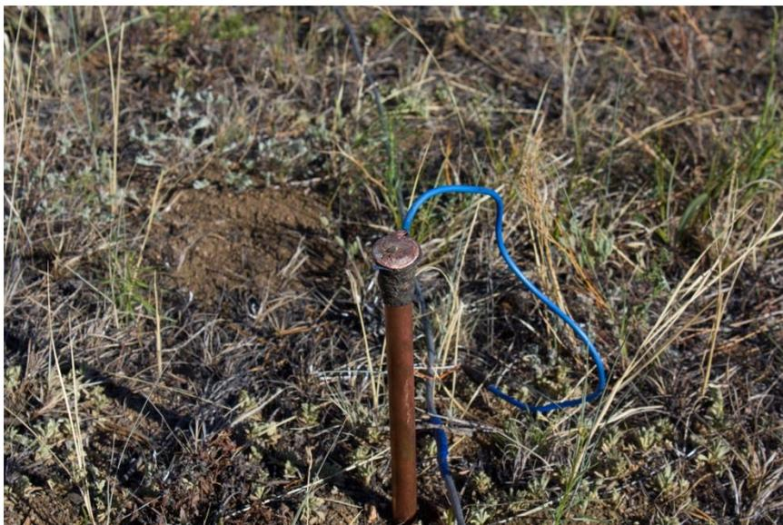
Рис.12. Заземление приемной линии.
