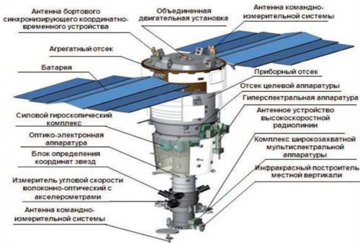
Рисунок 1. Структура искусственного спутника Земли для дистанционного зондирования Земли
