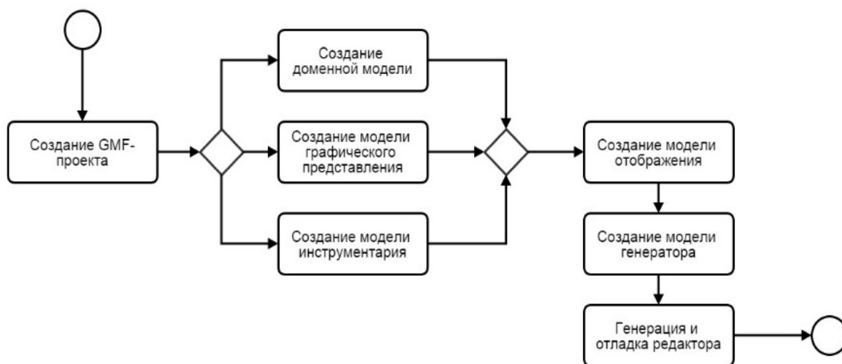
Рис. 3. Процесс разработки графического редактора с помощью технологии GMF
