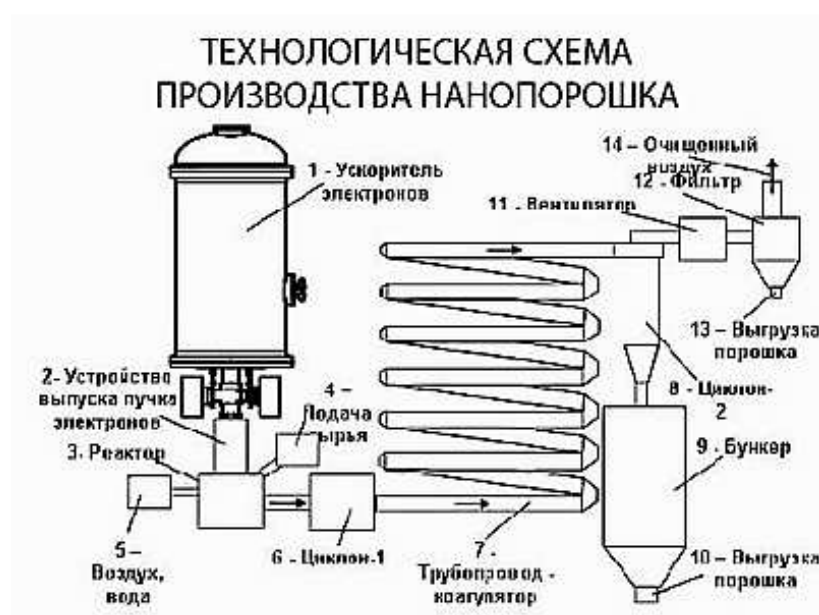
Рис. 3. Схема установки для получения нанопорошков титана[7]
