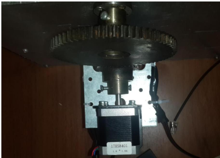
Рис.5. Шаговый двигатель и редуктор.
