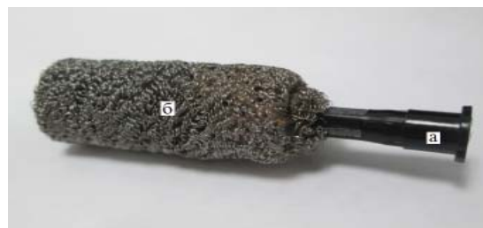
Дренаж собственной конструкции: а – конектор; б – дренажная часть из МР.
