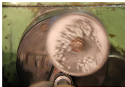
Рис. 2. Движение сыпучего материала в барабане, совершающем планетарное движение
