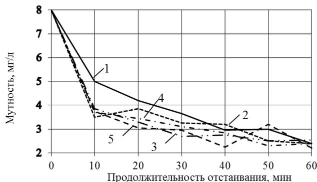
Рис. 8. Влияние вида и дозы реагентов на эффективность осветления промывной воды в летний период (июль, р. Тобол):
