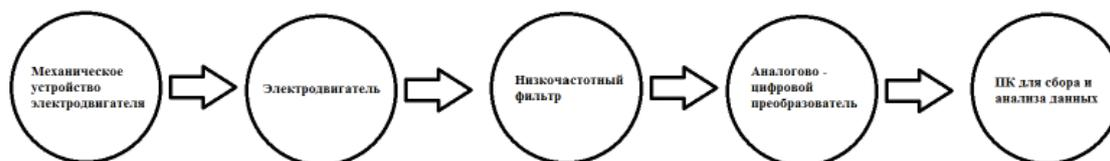
Рис. 1. Принципиальная схема измерительного комплекса для проведения диагностики электродвигателя
