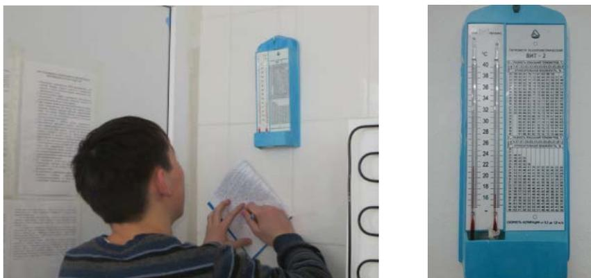
Рис. 2. Измерения, проводимые с помощью гигрометра психрометрического
