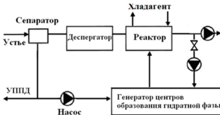
Рис. 1. Схема установки института SINTEF и компании BP [9]
