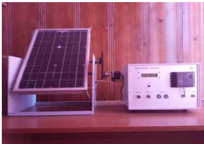
Рис. 3. Внешний вид системы позиционирования солнечной батареи
