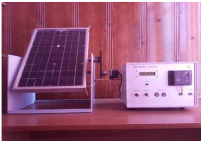
Рис. 3. Внешний вид системы позиционирования солнечной батареи
