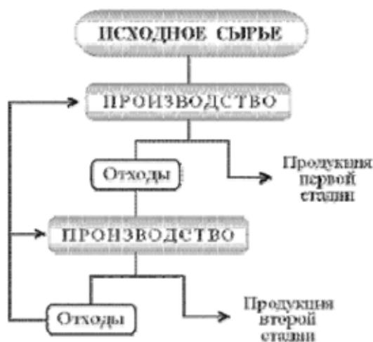
Рис. 1. Схема безотходного технологического процесса
