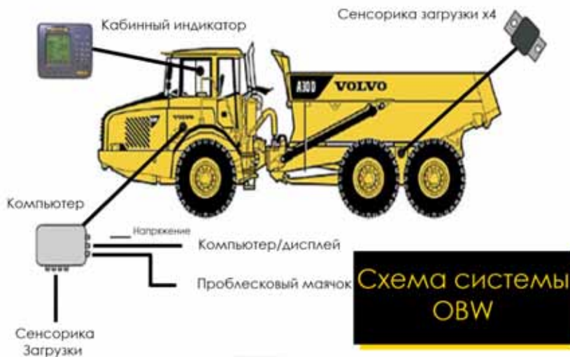
Рис. 1. Схема системы OBW на примере самосвала
