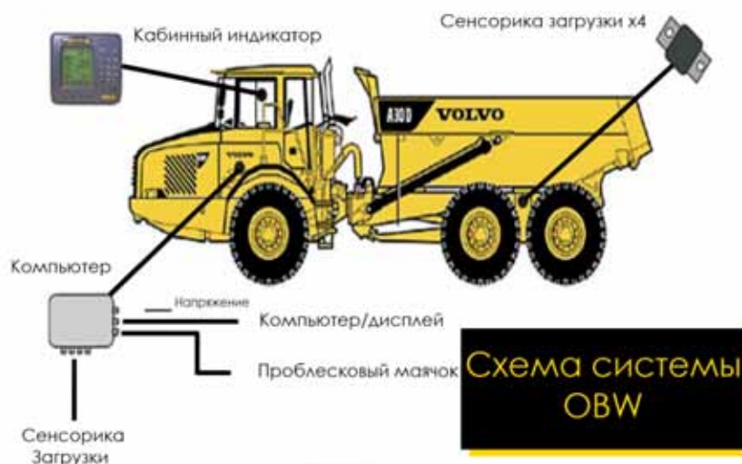
Рис. 1. Схема системы OBW на примере самосвала
