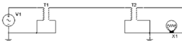
Рис. 1. Принципиальная схема однопроводной передачи электроэнергии
