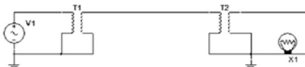
Рис. 1. Принципиальная схема однопроводной передачи электроэнергии
