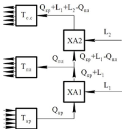
Схема тепловых потоков холодильной установки концентратора
