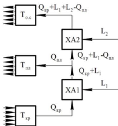
Схема тепловых потоков холодильной установки концентратора
