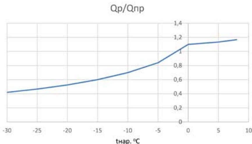
Рис. 4. Зависимость отношения тепла, отдаваемого через рекуператор к требуемому значению тепла для поддержания выбранной температуры внутри помещения от температуры наружного воздуха
