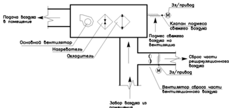
Рис. 2. Принципиальная схема крышного кондиционера марки DM
