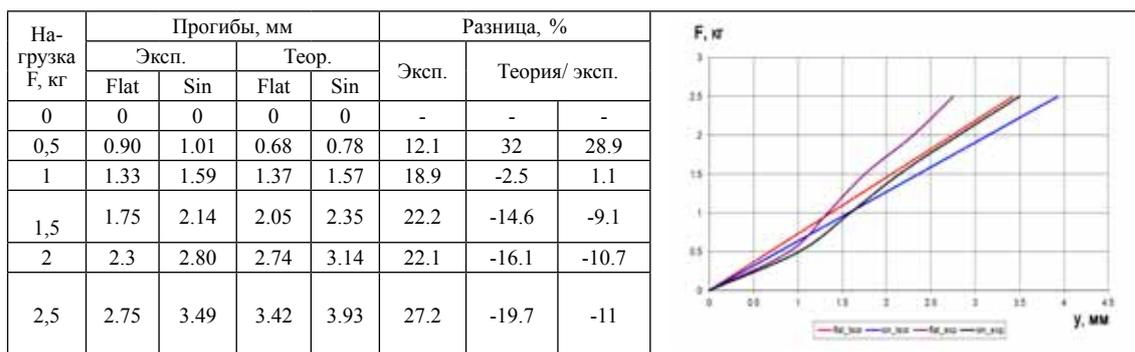
Рис. 6. Графики экспериментальных и теоретических прогибов балок
