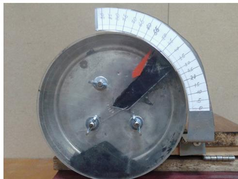
Установка для определения углов
