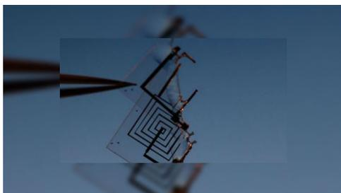
Рис. 4. Биоразлагаемая интегральная микросхема при растворении в воде
