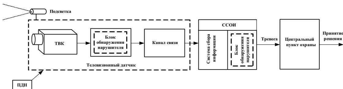
Рис. 2. Обобщенная структурная схема ТВТСО
