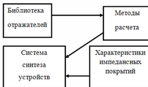
Структура подсистемы для синтеза сложных структур
