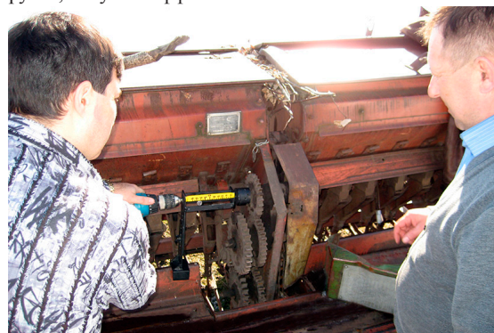
Рис. 4. Оценка технологической готовности зерновых сеялок в СПК «Карлинское» Ульяновской области с применением разработанного устройства
