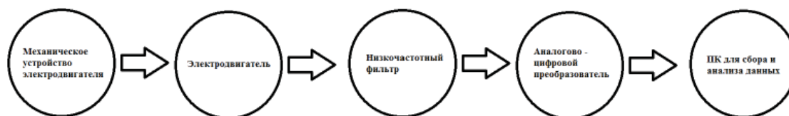
Рис. 1. Принципиальная схема измерительного комплекса для проведения диагностики электродвигателя
