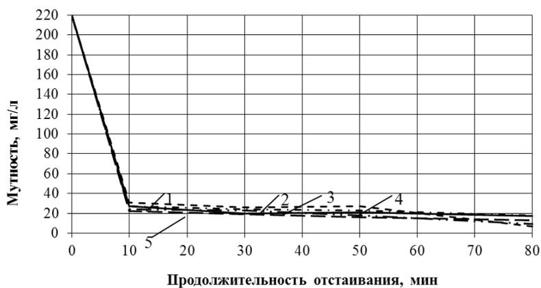
Рис. 4. Влияние дозы СА на эффективность осветления промывной воды в зимний период (январь, р. Тура)
