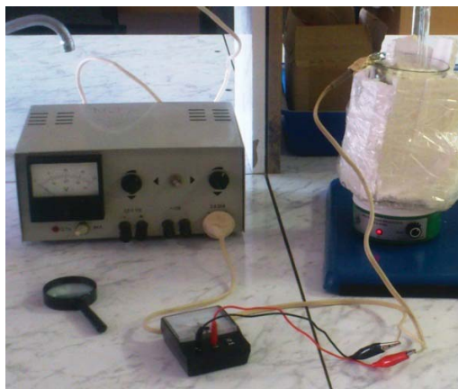
Схема установки, которая может быть использована для определения теплоемкостей жидкостей
