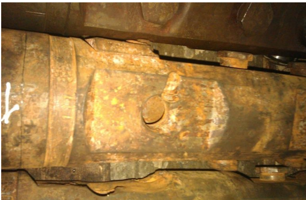
Рисунок 1 – Абразивный износ перфоратора
