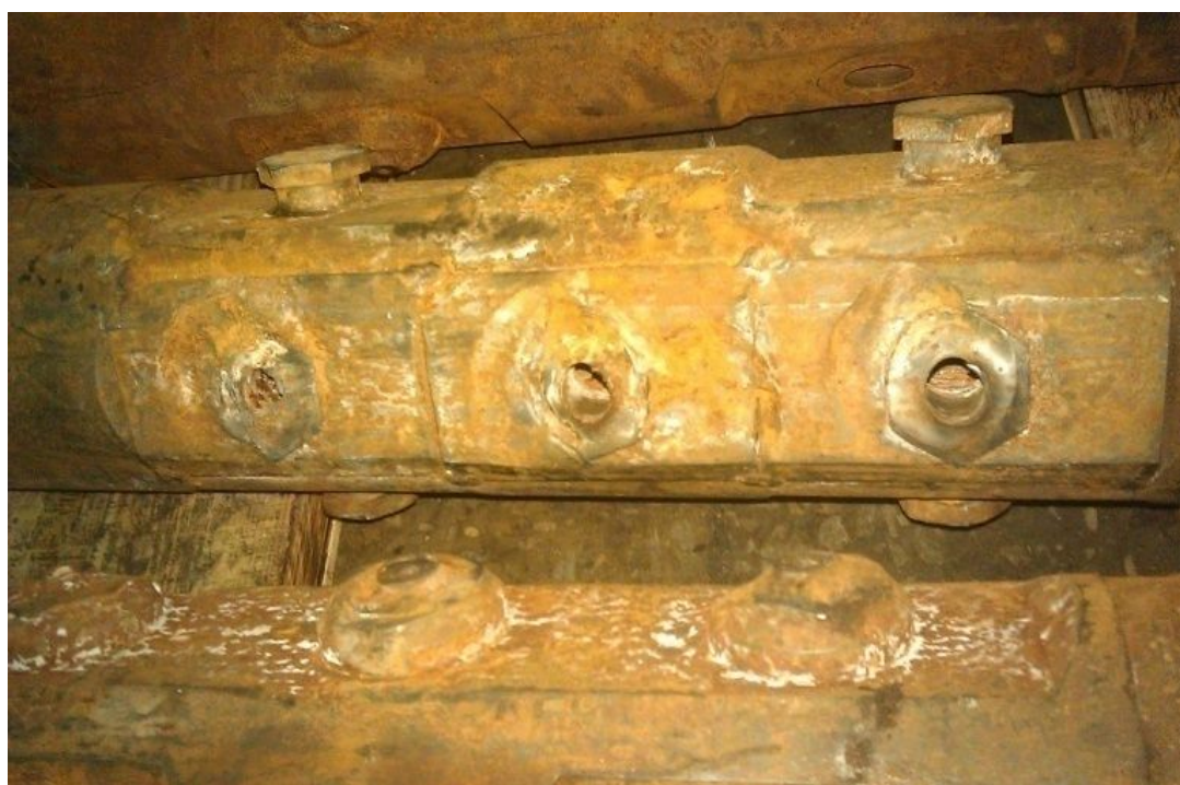
Рисунок 2 – Износ насадок перфоратора
