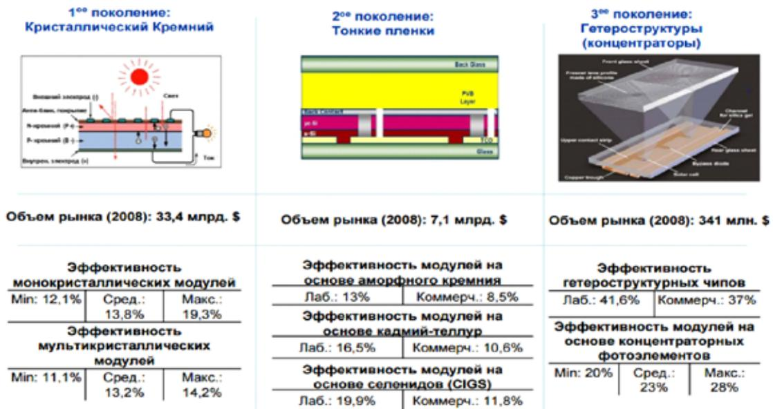
Рис. 3. Развитие технологий производства солнечных элементов
