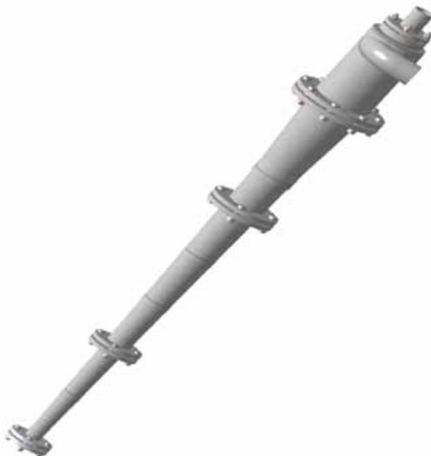
Рис. 4. Гидроциклон ГЦ – 170
