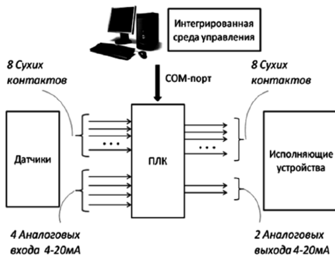
Рис. 1. Технические требования к ПЛК
