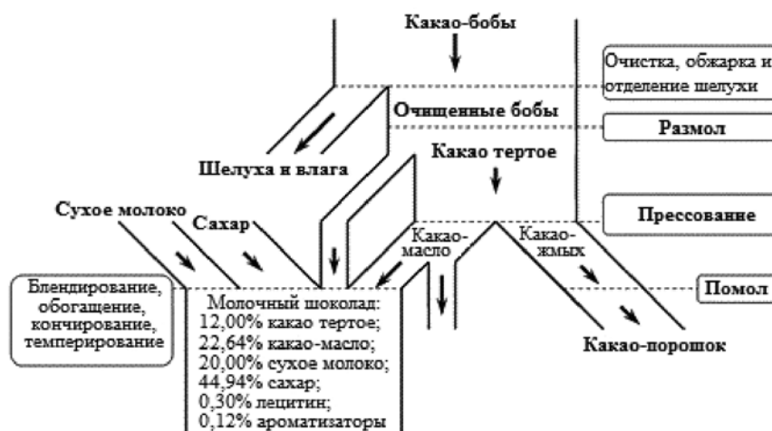
Схема комплексной переработки какао-бобов
