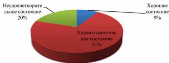
Рис. 1. Соотношение эксплуатируемых железобетонных мостов по техническому состоянию
