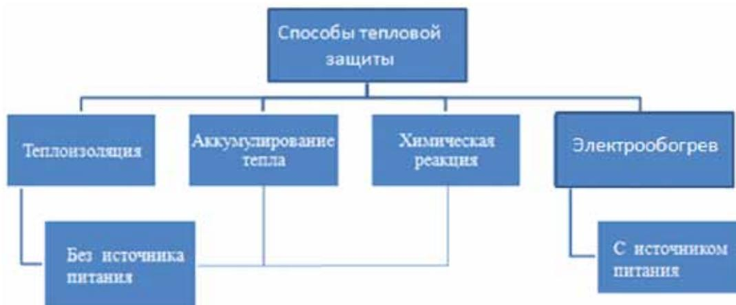
Рис. 1. Способы обеспечения искусственной тепловой защиты
