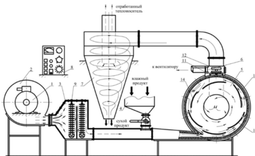
Рис. 1. Схема экспериментальной установки для СВЧ-сушки:
