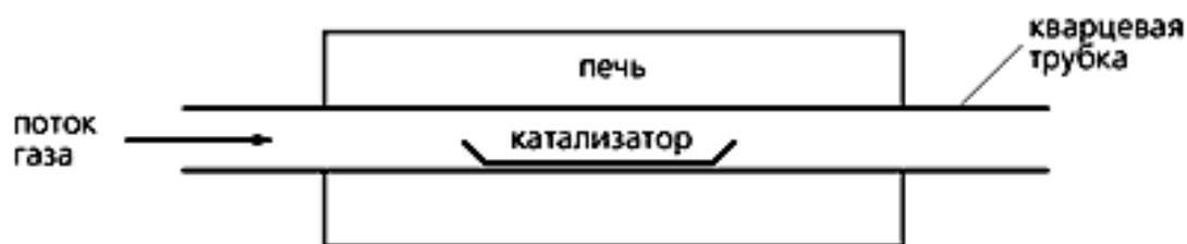
Рис. 9. Схема установки для получения нанотрубок методом химического осаждения [2].
