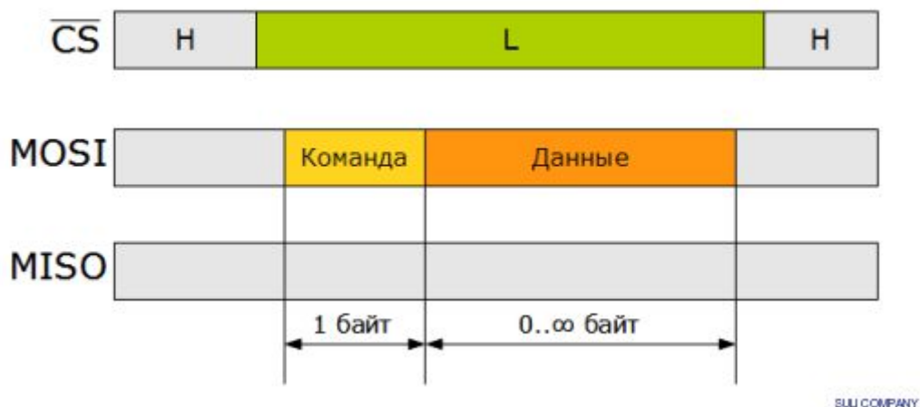
Рис.7. Диаграмма сигналов записи шине SPI.
