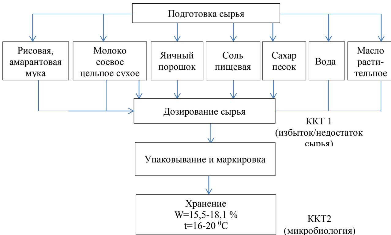
Рисунок 8 - Технологическая схема производства готовой сухой смеси для блинчиков полуфабрикат
