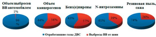
Рис. 1. Процентные соотношения выбросов ВВ от отработавших газов и в продуктах изнашивания шин [3]
