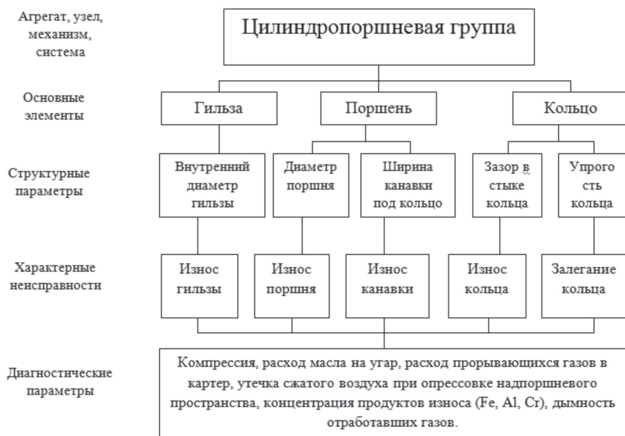
Структурно-следственная схема ЦПГ ДВС как объекта диагностирования [5]
