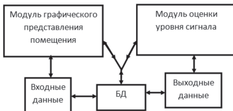
Рис. 1. Схема взаимодействия модуля оценки сигнала, модуля графического представления помещения и БД
