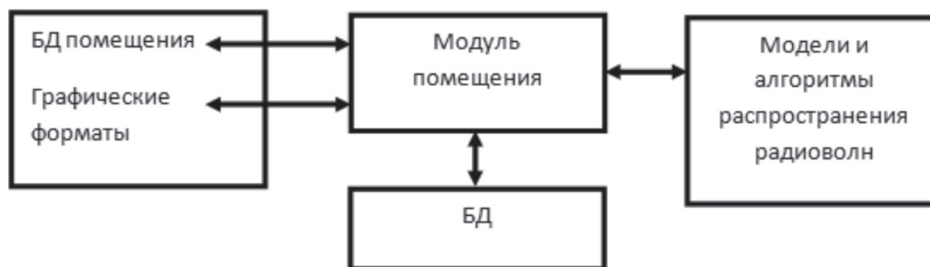
Рис. 2. Взаимодействие САПР беспроводных систем связи и графических пакетов
