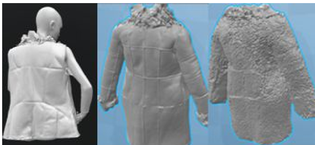
Рисунок 2 – Визуализация меховых изделий в среде Artec 3D: а – модель жилета из мехового велюра; б – модель пальто из мехового велюра; в – модель пальто из меховой овчины
