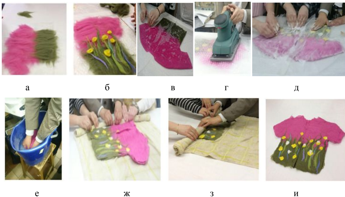
Рисунок 1 – Процесс изготовления образца изделия из войлока методом мокрого валяния с применением виброшлифовальной машины
