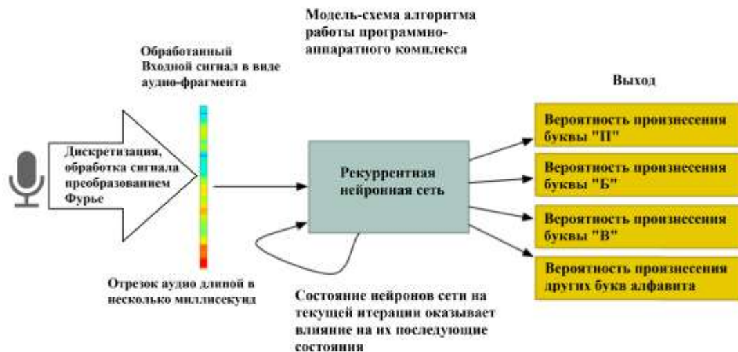
Рисунок 1 - Схема работы программного приложения
