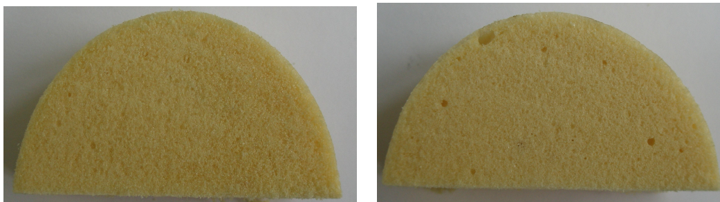
Рис.3 Структура ППУ: а) модифицированный ПФМС; б) немодифицированный;
