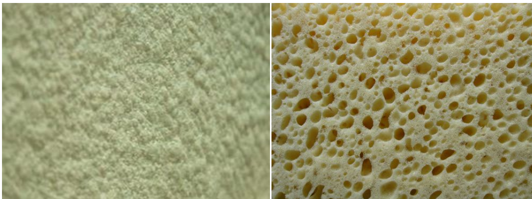
Рис. 1. Структура ППУ: а) Dabco DC5604; б) Dabco LK-221E;
