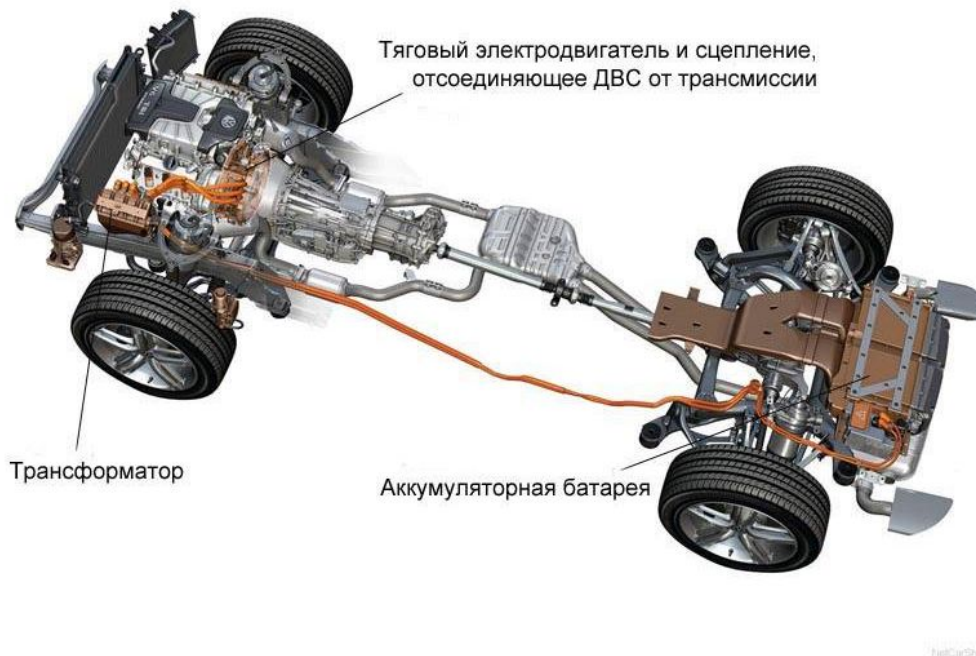
Рисунок 3. схема параллельного гибрида на примере автомобиля Volkswagen Touareg Hybrid
