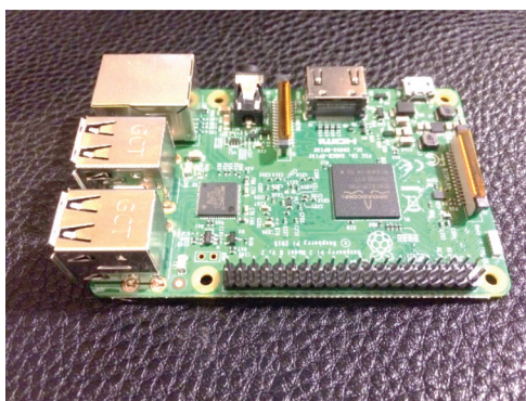
Рис. 6. Микрокомпьютер Raspberry Pi3
