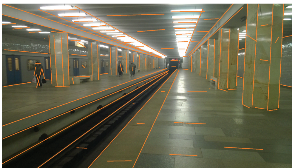
Рис. 2. Графическая реализация алгоритма SLAM на собственном примере
