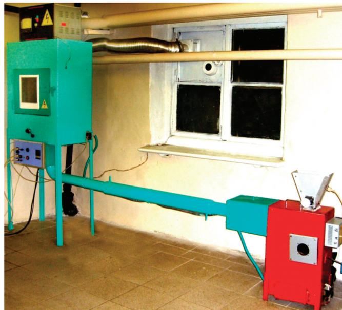
Установка электростатического копчения твердого сыра с индуктивным подводом энергии при дымогенерации в среде инертного газа:
