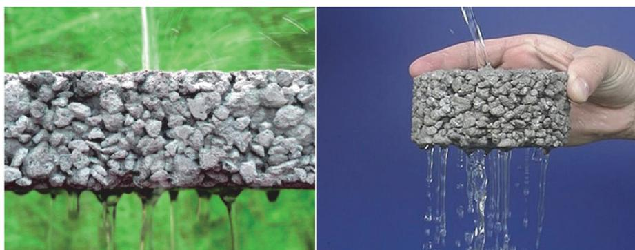
Рис. 2. Водопроницаемость органического бетона
