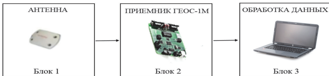
Рис. 2. Структурная схема программно-аппаратного комплекса для натурального эксперимента
