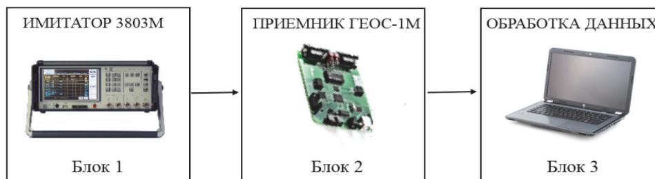
Рис. 3. Структурная схема программно-аппаратного комплекса для полунатурного эксперимента
